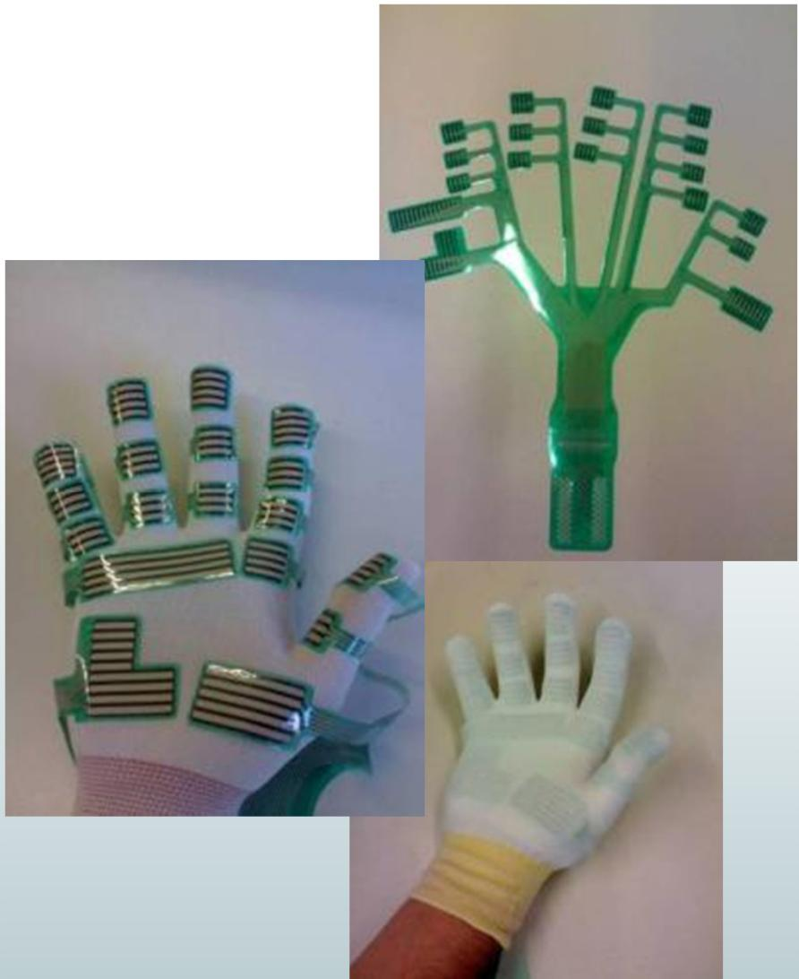
Sensore per la rilevazione del carico sulla mano dell'Operatore:
