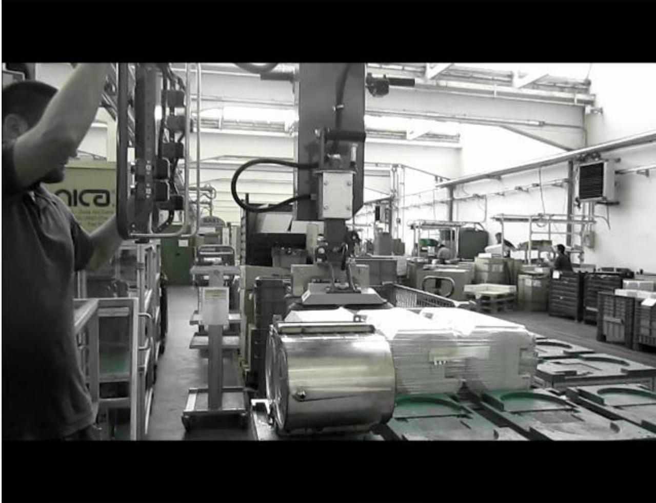
Stazione di lavoro prevedeva inizialmente l'impiego di **2 operatori** per l'estrazione e la rotazione del pezzo dalla confezione con rischi sia per la sicurezza sia per la movimentazione manuale dei carichi.
