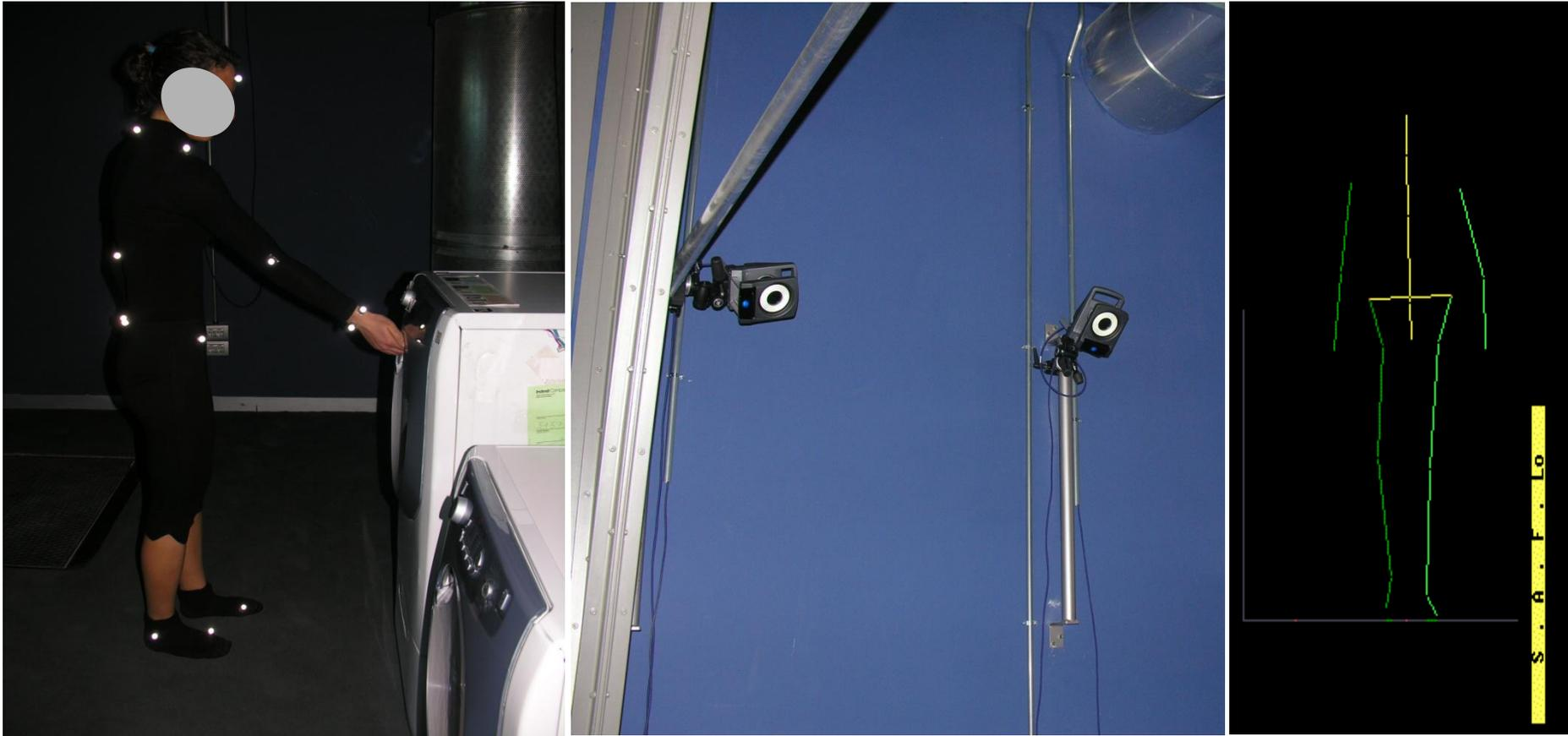
**Basati su sistemi di telecamere infrarosse che rilevano degli specifici marcatori e ricostruiscono il movimento in 3 D**
